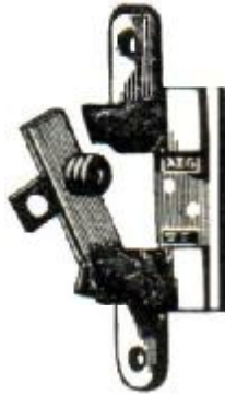
Figura 19 PRIMITIVO SECCIONADOR UNIPOLAR DE ALTA TENSIÓN
